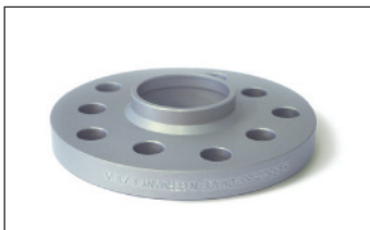
Artikel-Nr./Part-no. 30255570: Radnabengänge max. 17 mm. Felgeninnenfase mind. 4x45° Wheel hub length max. 17 mm. Inner bevel 4x45°.
