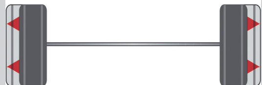
Spurverbreiterungen von 10-90 mm möglich Track increase available from 10-90 mm
