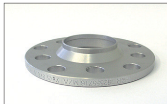
Artikel-Nr./Part-no. 162555716: Radnabengänge max. 14 mm. Felgeninnenfase mind. 7x45° Wheel hub length max. 14 mm. Inner bevel 7x45°.
