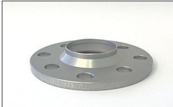
Artikel-Nr./Part-no. 162345712: Radnabengänge max. 14 mm. Felgeninnenfase mind. 7x45° Wheel hub length max. 14 mm. Inner bevel 7x45°.
