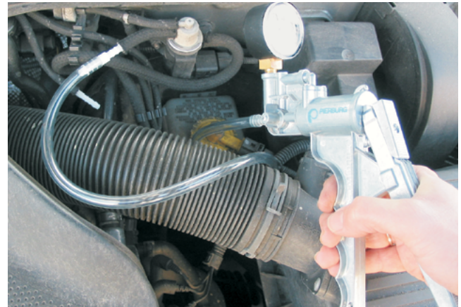
Prüfung eines Druckwandlers mit der Handunterdruckpumpe an einem VW Golf IV (Pierburg Art. Nr. 12 00001 11 900)
