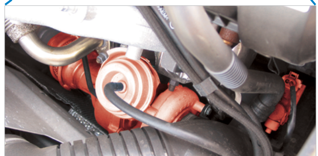
Druckwandler und VTG-Lader (rot hervorgehoben) im Audi A4 TDI
